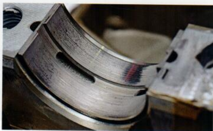
Hauptlagerschale mit deutlichen Laufspuren, aber noch im grünen Bereich
