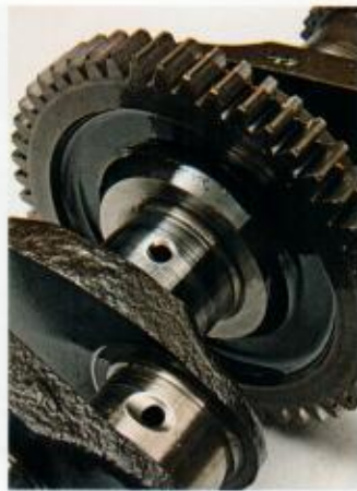
Kurbelwellen-Hauptlager. Dezentere Laufspuren, mehr nicht
