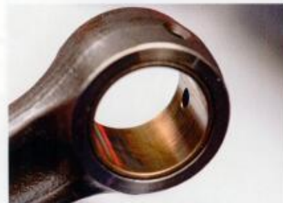
Heute eine Seltenheit: Pleuelauge mit zusätzlicher Bronzebuchse
