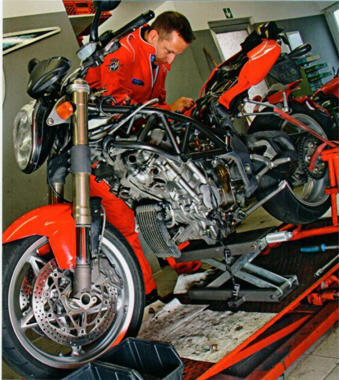
Eng vollgebaut, aber durchdacht und servicefreundlich. Der Rahmen etwa lässt sich über den Motor hochklappen
