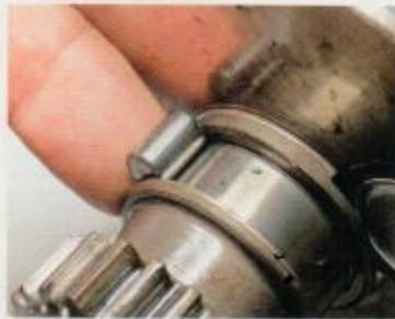
Die Rollen der Kurbelwellenlager laufen direkt auf der Welle, was eine Reparatur im Ernstfall sehr aufwendig macht
