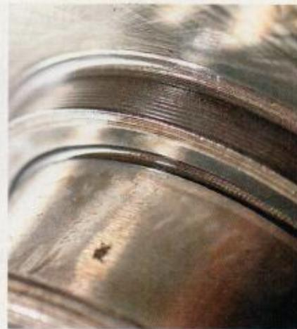
Die Laufflächen der Hauptlager müssen abgestochen werden, damit die Rollen auf voller Länge tragen
