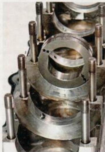
Die zweiteiligen (Außen-)Lagerschalen werden durch Fixierringe und Stifte mit unterschiedlich großen Ölbohrungen (r.) im Bankett arretiert
