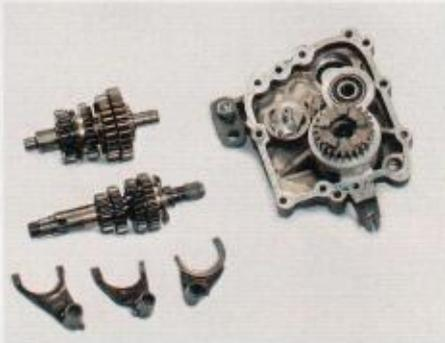
Noch so eine Spezialität: Das Kassettengetriebe lässt sich als Einheit aus dem Motorgehäuse ziehen
