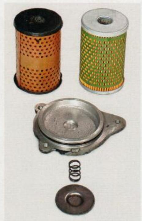
Die federbelastete Druckscheibe im Ölfiltergehäuse stellt sicher, dass auch im Falle eines zugesetzten Filters Schmierstoff im Umlauf bleibt
