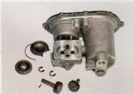
Völlig unproblematisch: Die Zahnrad-Ölpumpe ist gut dimensioniert und arbeitet zuverlässig
