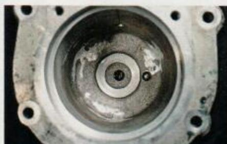
...Filtergehäuse wie hier gezeigt entfernt, kann auf moderne Bosch- oder Mann-Filter zurückgreifen
