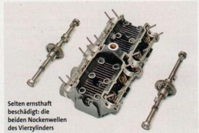
Selten ernsthaft beschädigt: die beiden Nockenwellen des Vierzylinders
